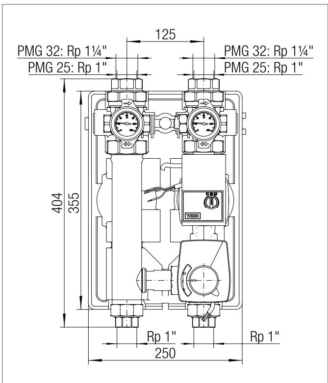
Рис. 25-10 Размеры насосной смесительной группы PMG-25/32 ErP
