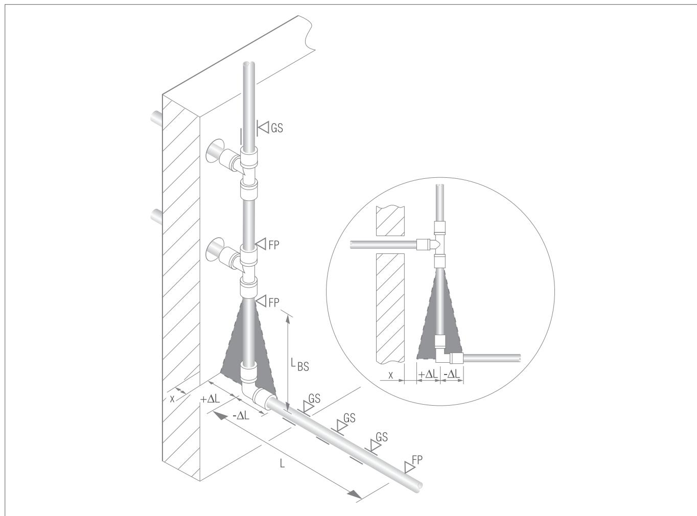
Рис. 8-1 Компенсатор
