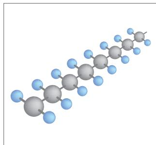
Рис. 1-3 Полиэтилен (PE)
