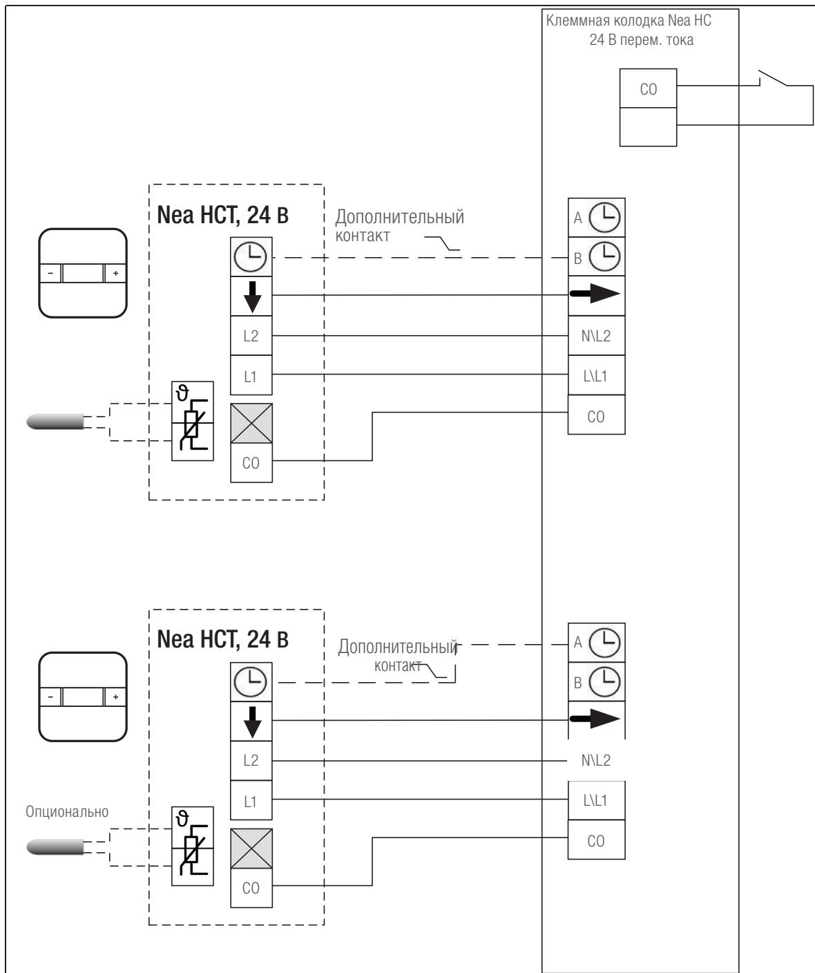
Рис. 26-9 Схема электрического подключения терморегуляторов Nea HCT к клеммной колодке HC 24 В
