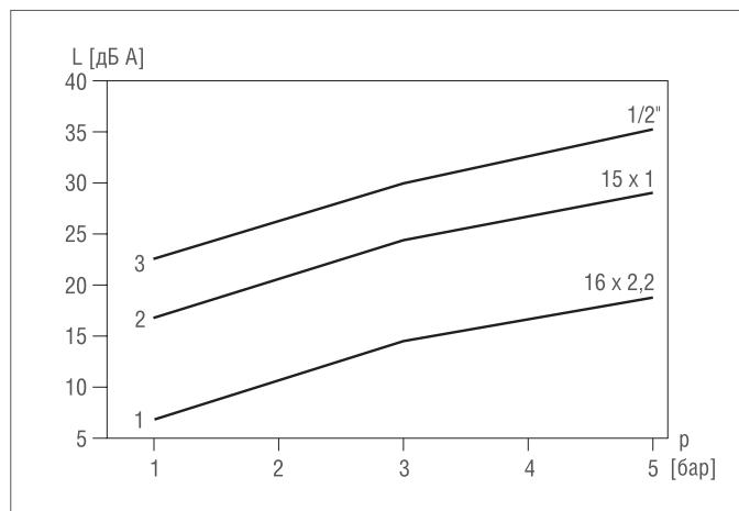
Рис. 6-3 Результат испытания Института им. Фраунхоффера: сравнительный анализ шумоизолирующих характеристик материалов труб
