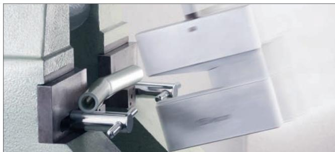
Рис. 2-2 Универсальная труба RAUTTAN flex в установке по испытанию ударной вязкости
