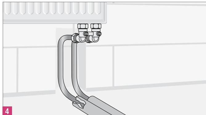
Рис. 14-8 Прямое подключение труб RAUTITAN stabil к отопительному прибору со встроенным вентилем
