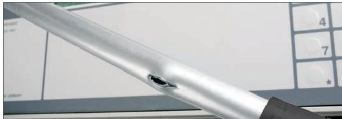
Рис. 2-1 Результаты испытания прочности на разрыв давлением.
