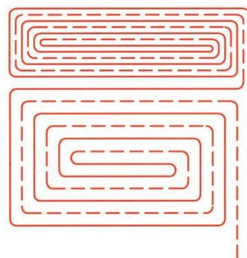
Рис. 21-12 Способ укладки «улитка» с присоединенной границной зоной
