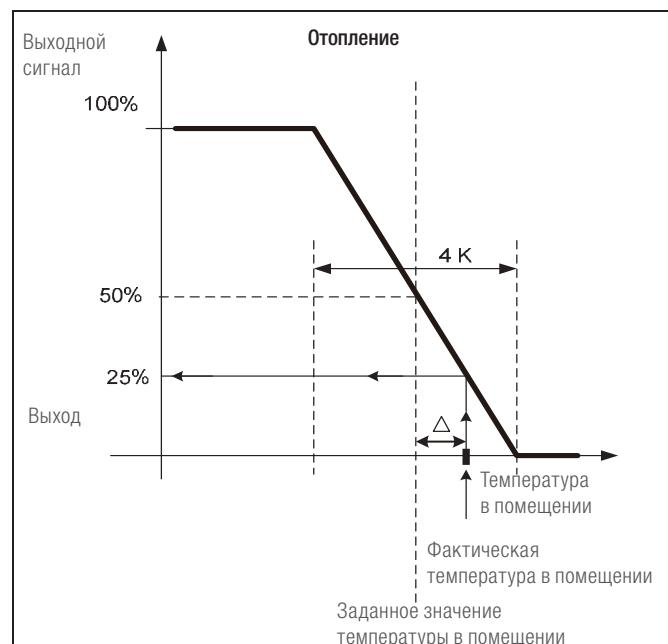
График показывает принцип действия пропорционального регулятора (П-регулятора) в режиме отопления. Ширина зоны пропорциональности составляет 4 К, значение выходного сигнала предустановлено в настройках параметра PE08 на уровне 50%.
