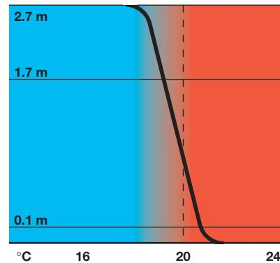
Рис. 20-2 Идеальное распределение температур
