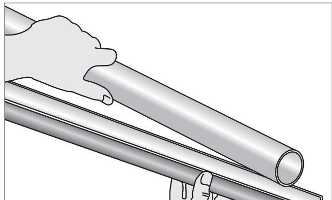
Рис. 9-8 Надевание на трубу
