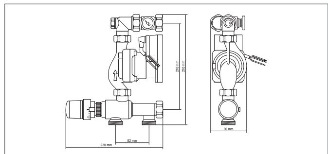
Рис. 25-5 Комплект регулирования flex
