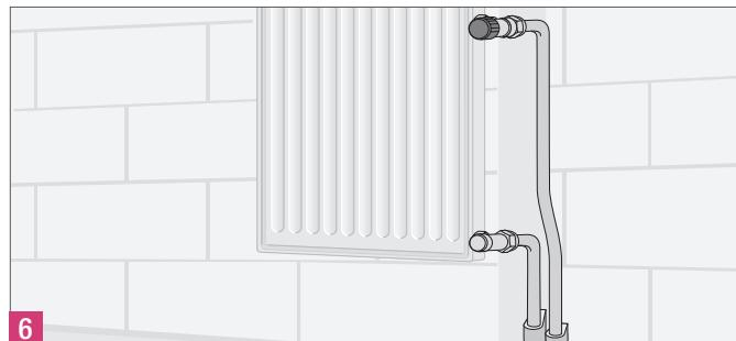
Рис. 14-12 Подключение к запорно-регулировочной арматуре радиатора с помощью переходника с наружной резьбой RAUTITAN MX
