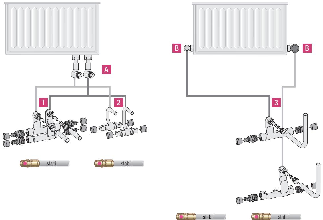
Рис. 16-3 Общий вид подключений к отопительным приборам в плинтусной разводке
