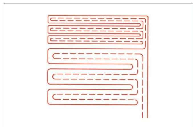
Рис. 21-16 Укладка двойным змеевиком с подсоединененным граничным контуром
