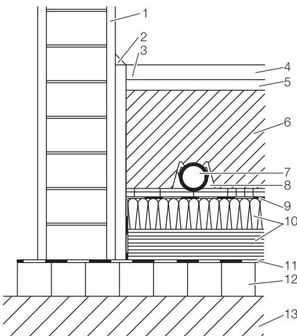
Рис. 21-50 Шина RAUFIX с уложенной трубой RAUTHERM S в разрезе
