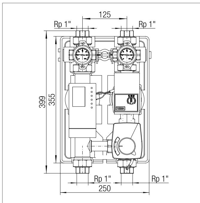
Рис. 25-8 Размеры станции температурного регулирования TRS-20 ErP
