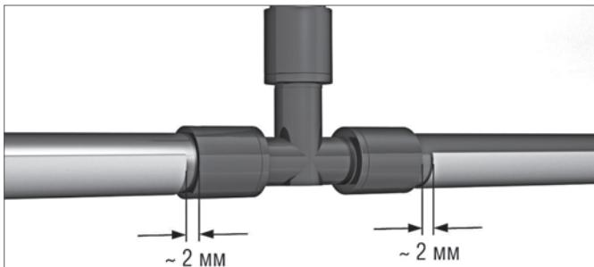
Рис. 9-5 Фиксирующий желоб недопустимо прокладывать поверх надвижных гильз RAUTITAN PX
