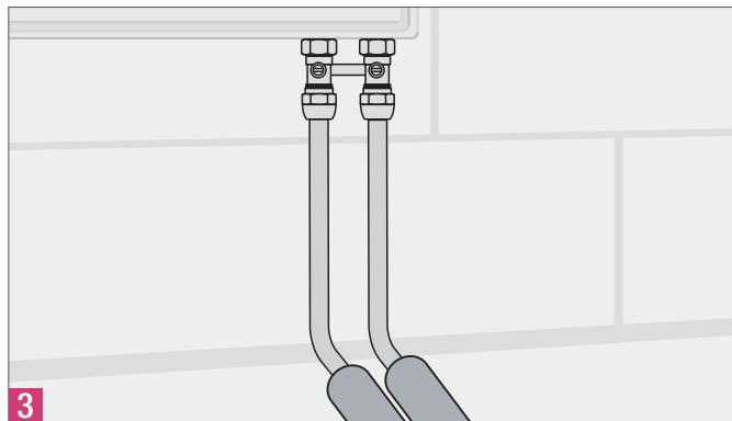
Рис. 13-8 Подключение отопительного прибора при помощи универсальной трубы RAUTITAN stabil с блоком шаровых кранов
