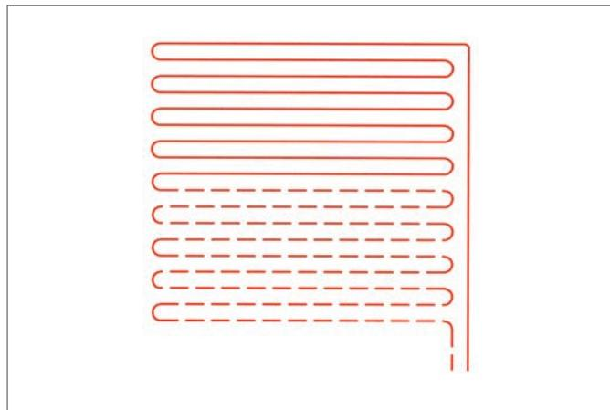
Рис. 21-13 Укладка змеевиком
