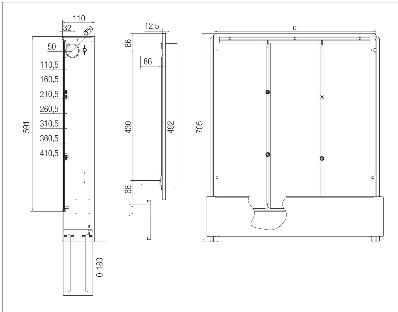
Рис. 24-7 Размеры распределительного шкафа UP 75 мм
