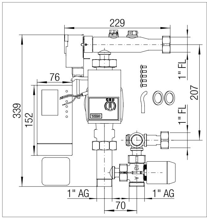
Рис. 25-3 Размеры станции регулирования температуры TRS-V ErP
