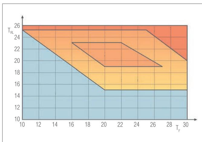
Рис. 20-1 Термальный комфорт в зависимости от сочетания температуры воздуха в помещении  $T_{RL}$  и температуры внутренних поверхностей помещения  $T_F$
