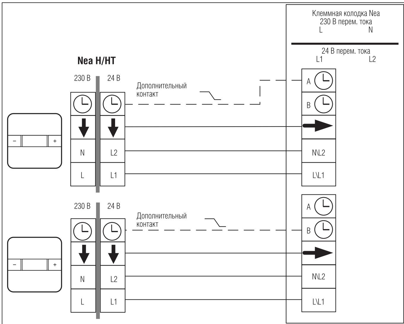
Рис. 26-7 Схема электрического подключения терморегуляторов Nea H, Nea HT к клеммной колодке Nea H 230 B/24 В
