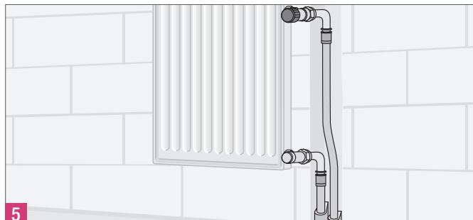
Рис. 14-10 Подключение к запорно-регулировочной арматуре радиатора при помощи Г-образных присоединительных трубок
