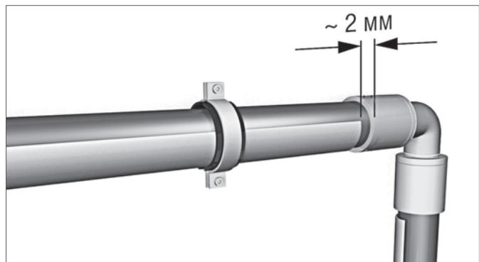
Рис. 9-2 Фиксирующий желоб должен не доходить до надвижной гильзы на 2 мм
