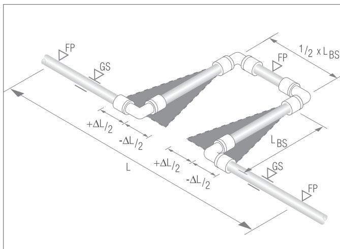
Рис. 8-2 П-образный компенсатор
