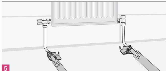
Рис. 13-12 Разностороннее подключение отопительного прибора при помощи Г-образных присоединительных трубок RAUTITAN через запорно-регулировочную арматуру
