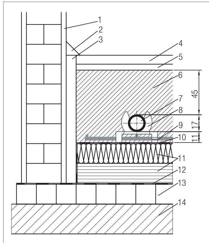
Рис. 21-66 Маты с арматурными сетками (RTM) с поворотными клипсами для закрепления трубы RAUTHERM S
