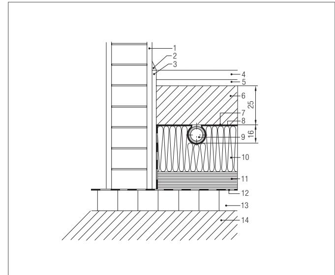
Рис. 22-10 «Сухая» система с проложенной трубой RAUTHERM S
