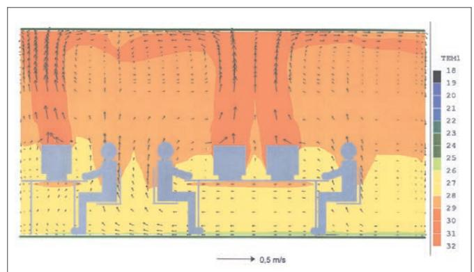
Рис. 20-6 Температура и подвижность воздуха при использовании системы напольного охлаждения
