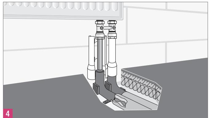
Рис. 13-10 Присоединение отопительного прибора с использованием присоединительного комплекта
