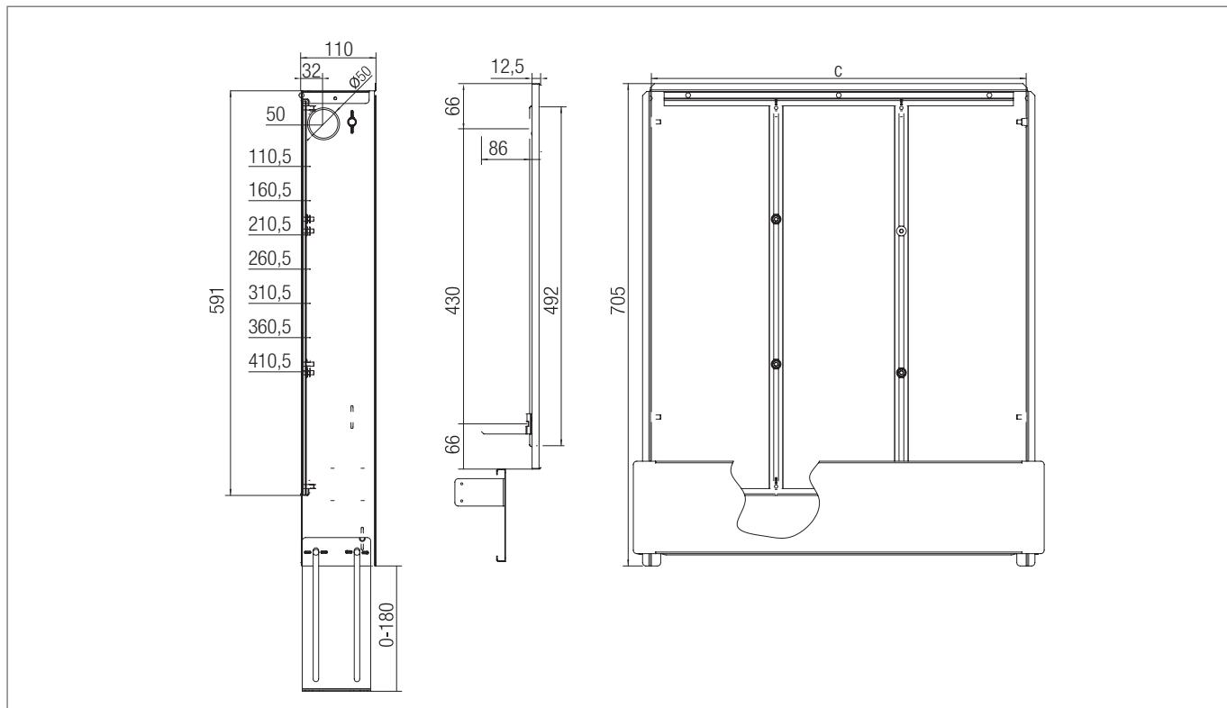
Рис. 24-13 Размеры распределительного шкафа UP 75 мм
