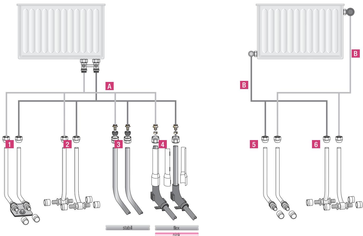
Рис. 13-1 Общий вид подключений к отопительным приборам из пола
