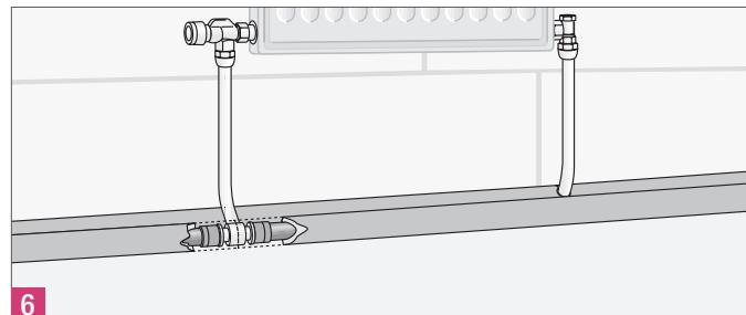
Рис. 13-14 Разностороннее подключение отопительного прибора при помощи Т-образных присоединительных трубок RAUTITAN через запорно-регулировочную арматуру
