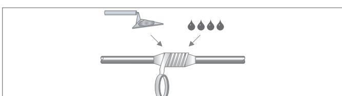
Рис. 18-3 Антикоррозионная защита металлических соединительных элементов
