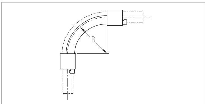
Рис. 11-6 Фиксаторы поворота (водоснабжение) – 90° и фиксаторы поворота (водоснабжение / отопление) (5 x Ø) – 90° для гнутья труб Ø 32
