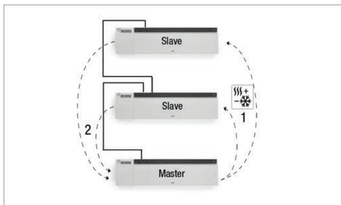
Рис. 27-9 Обмен данными между главной и подчинёнными базами
