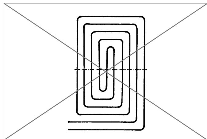
Рис. 21-11 Неправильное расположение шва и контуров
