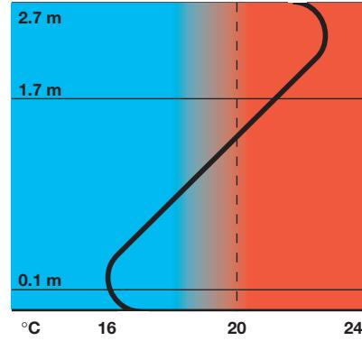
Рис. 20-4 Радиаторное отопление
