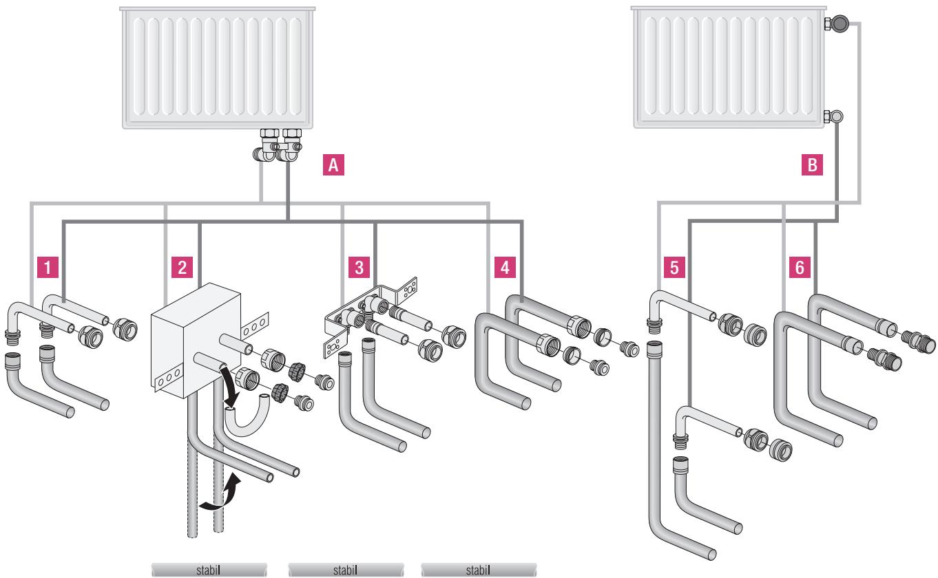
Рис. 14-1 Общий вид подключений к отопительным приборам из стены
