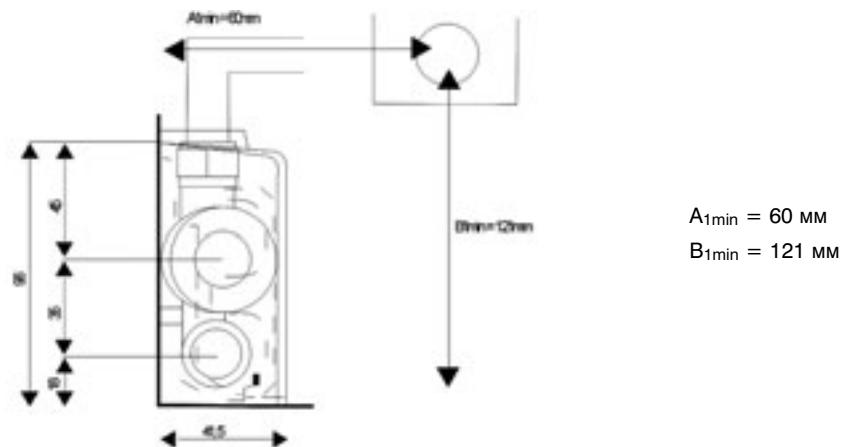
Рис. 121. Минимальные монтажные расстояния при разностороннем подключении отопительного прибора .
