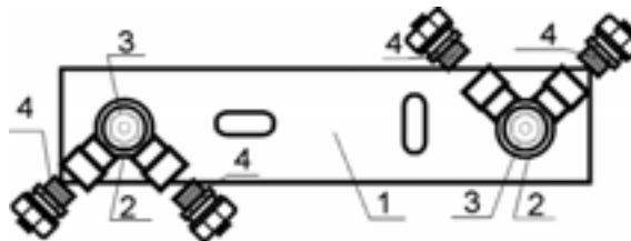
Рис. 242. УЗЕП «PPOD-S18» «PPOD-S25» - две водоразборные точки с ответвлениями на холодную и горячую воду к последующим водоразборным точкам.
