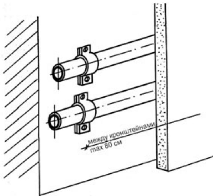
Рис. 48. Открытая прокладка труб за гипсокартонными плитами.
