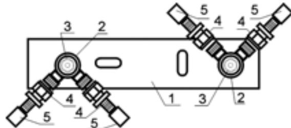
Рис. 243. УЗЕП «PPOD-SR18k» - две водоразборные точки с ответвлениями (угловыми) на холодную и горячую воду к последующим водоразборным точкам.
