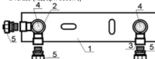
Рис. 251. УЗЕП «PPOC-S18k» «PPOC-S25k» - две водоразборные точки с ответвлением на горячую воду к последующей водоразборной точке.
