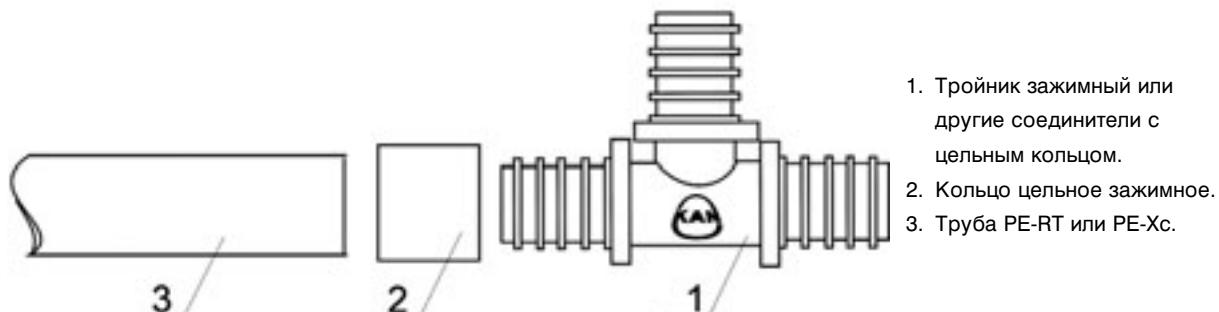
Рис. 14. Схема соединения с цельным кольцом, натягиваемым прессом.
