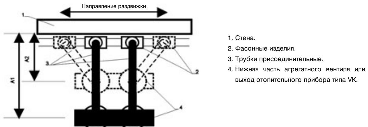
Рис. 126. Регулирование монтажного расстояния при помощи трубок типа Z.
