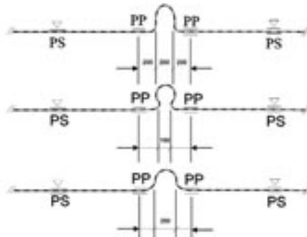
Рис. 50. Действие Пчобразного компенсатора.
