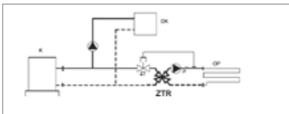
Рис. 146. Схема смесительной системы с полуавтоматическим регулированием:
