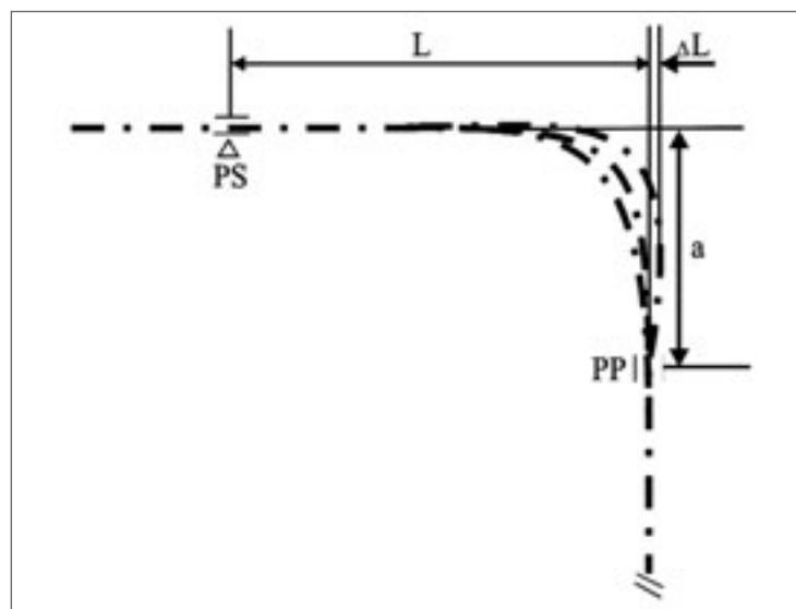
Рис. 49. Самокомпенсация труб PE-RT, PE-Xc, PE-RT/AI/PE-HD.
