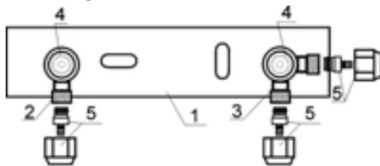
Рис. 260. УЗЕЛ «PPOZ-SR16k» - две водоразборные точки с ответвлением (угловым) на холодную воду к последующей водоразборной точке.
