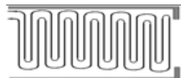
Рис. 137а. Спиральный контур в форме меандра применяется в случае длинных и узких полов с многочисленными разделительными швами.
