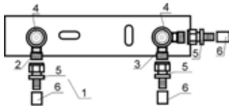
Рис. 248. УЗЕП «PPOZ-SR18k» - две водоразборные точки с ответвлением (угловым) на холодную воду к последующей водоразборной точке.
