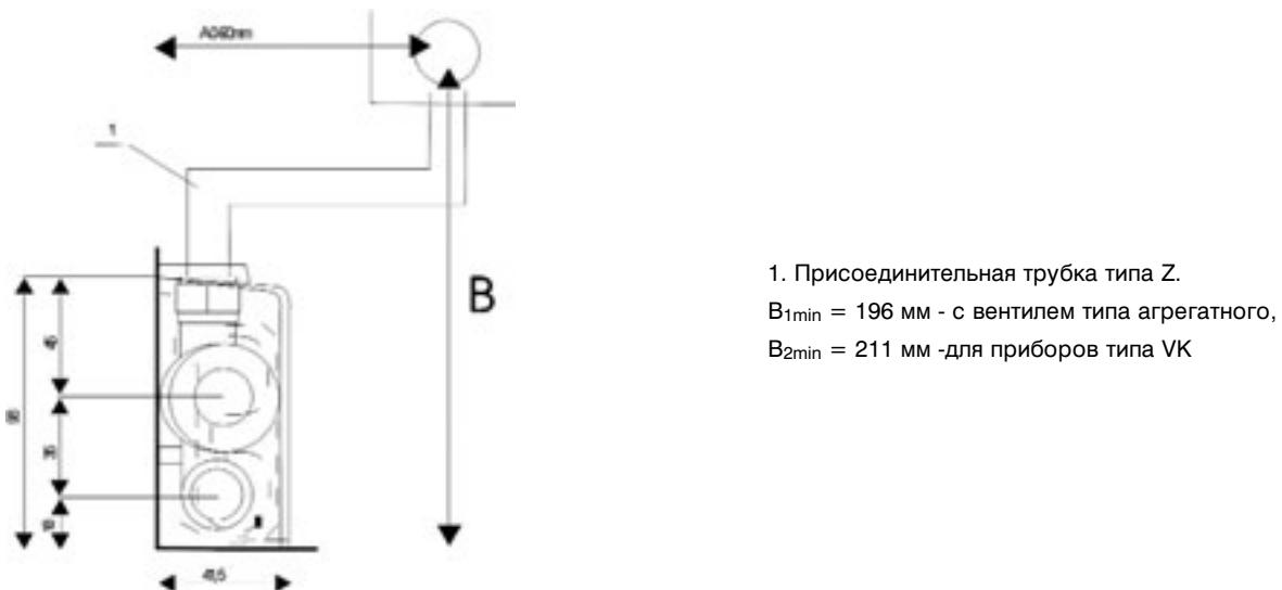
Рис. 123. Подключение отопительного прибора при помощи присоединительных трубок типа Z.
