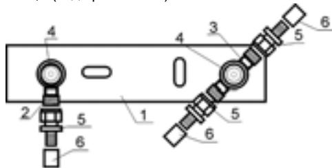
Рис. 249. УЗЕП «PPOZ-SR18r» - две водоразборные точки с ответвлением (проходным) на холодную воду к последующей водоразборной точке.
