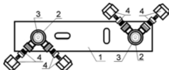
Рис. 258. УЗЕЛ «PPOD-SR16k» - две водоразборные точки с ответвлениями (угловыми) на холодную и горячую воду к последующим водоразборным точкам.
