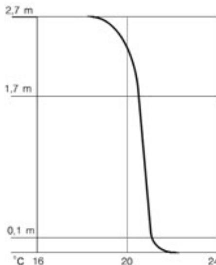
Рис. 130. Пример распределения температуры при подпольном отоплении
