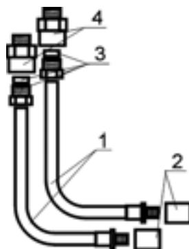
Рис. 240. УЗЕП «PPK-ZT18» две водоразборные точки конечные холодной и горячей воды.
