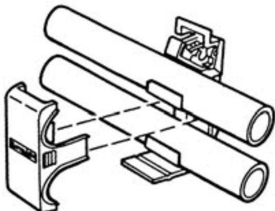
Рис. 113. Монтаж передней части кронштейна.
