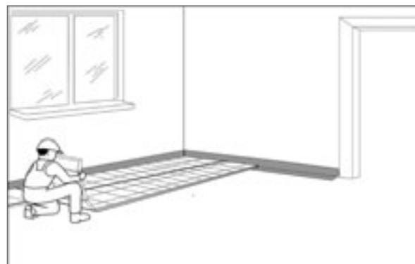
Рис.141. Разложить пенополистирол с верхним слоем из ПЕ.
