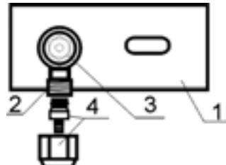
Рис. 254. УЗЕП «PP-SR16» - одна водоразборная точка холодной или горячей воды.
