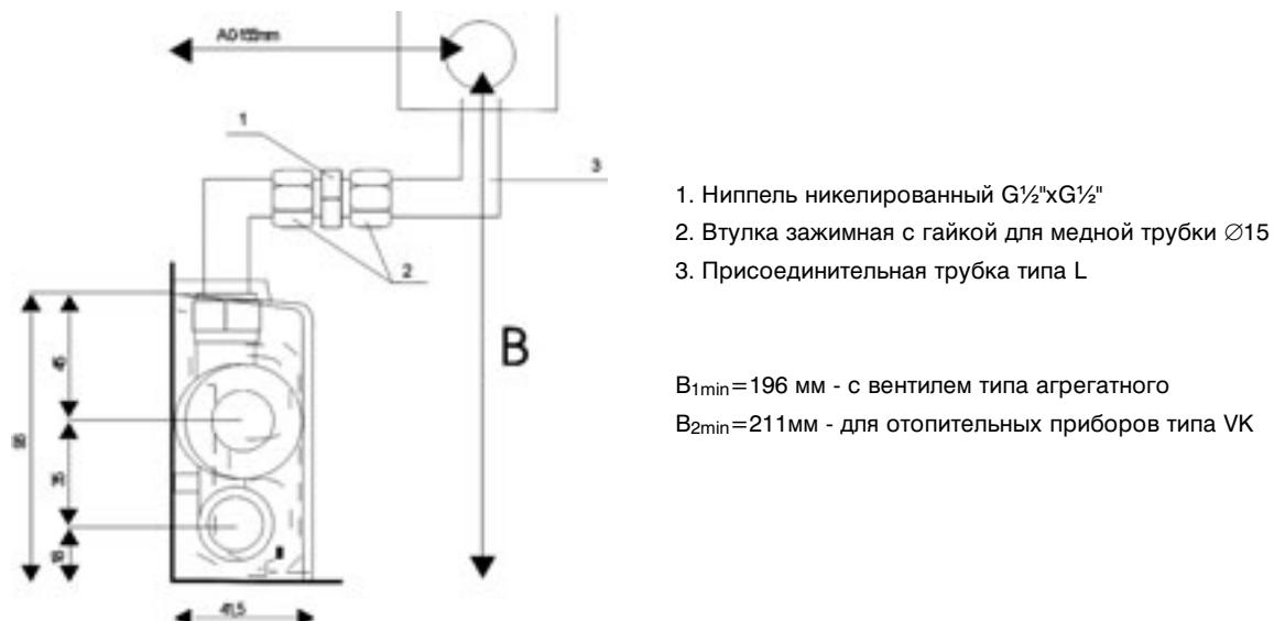
Рис. 124. Подключение отопительного прибора при помощи трубы типа L с ниппелем.
