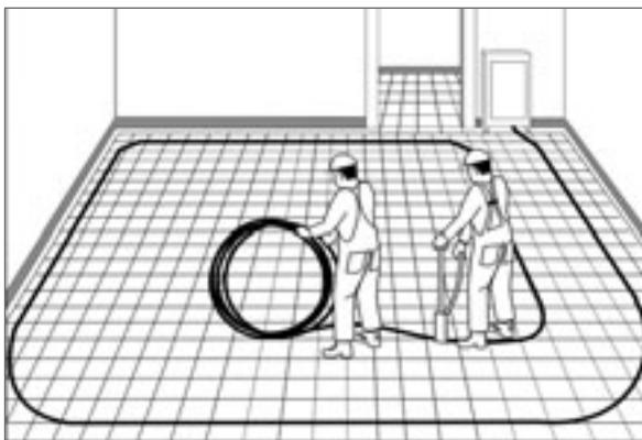
Рис. 142. Поддающую часть трубы подключить к распределителю, укладывать с требуемой плотностью и в соответствующих местах закрепить трубу шпильками.
