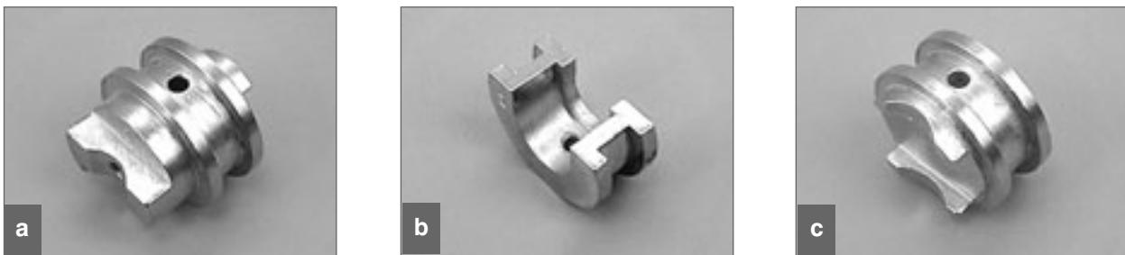
Рис. 28. Вкладыши для пресса: а) фасонный для латунных тройников, б) простой для кольца и латунных фасонных изделий, имеющих фланцы с отступом, в) фасонный для тройников и отводов фиксируемых.
