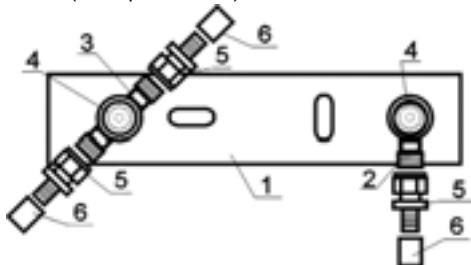
Рис. 253. УЗЕП «PPOZ-SR18p» - две водоразборные точки с ответвлением (проходным) на горячую воду к последующей водоразборной точке.
