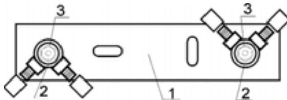
Рис. 241. УЗЕП «PPOD-Z18» - две водоразборные точки с ответвлениями на холодную и горячую воду к последующим водоразборным точкам.
