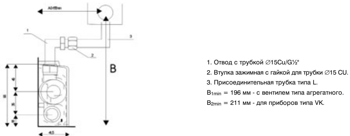
Рис. 122. Подключение отопительного прибора при помощи трубок типа L и отвода с трубкой.
