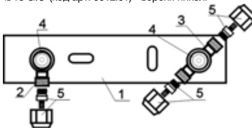
Рис. 261. УЗЕЛ «PPOZ-SR16p» - две водоразборные точки с ответвлением (проходным) на холодную воду к последующей водоразборной точке
