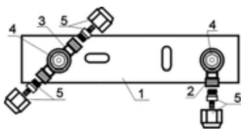
Рис. 263. УЗЕЛ «PPOC-SR16p» - две водоразборные точки с ответвлением (проходным) на горячую воду к последующей водоразборной точке
