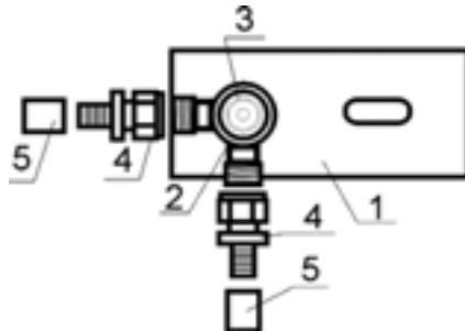
Рис. 234. УЗЕЛ «PPO-SR18k» - одна водоразборная точка с ответвлением (угловым) на холодную или горячую воду к последующей водоразборной точке.
