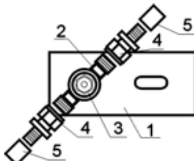
Рис. 235. УЗЕЛ «PPO-SR18p» - одна водоразборная точка с ответвлением (проходным) на холодную или горячую воду к последующей водоразборной точке.
