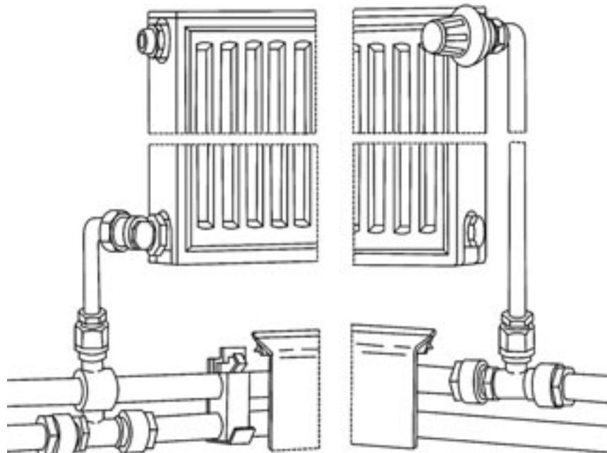
Рис. 115. Схема разностороннего (скрещенного) подключения отопительного прибора.
