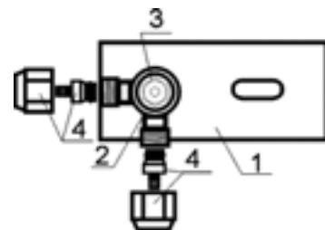
Рис. 255. УЗЕП «PPO-SR16k» - одна водоразборная точка с ответвлением (угловым) на холодную или горячую воду к последующей водоразборной точке.
