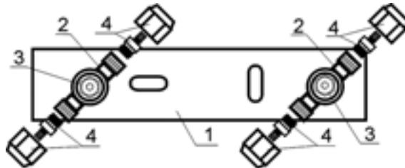
Рис. 259. УЗЕЛ «PPO-SR16p» - две водоразборные точки с ответвлениями (проходными) на холодную и горячую воду к последующим водоразборным точкам.
