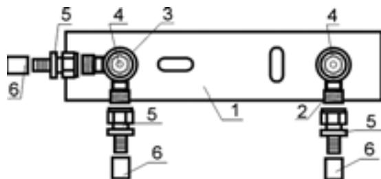
Рис. 252. УЗЕП «PPOS-SR18k» - две водоразборные точки с ответвлением (угловым) на горячую воду к следующей водоразборной точке.
