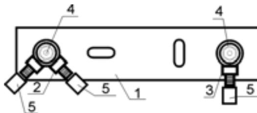
Рис. 250. УЗЕП «PPOC-Z18» - две водоразборные точки с ответвлением на горячую воду к последующей водоразборной точке.
