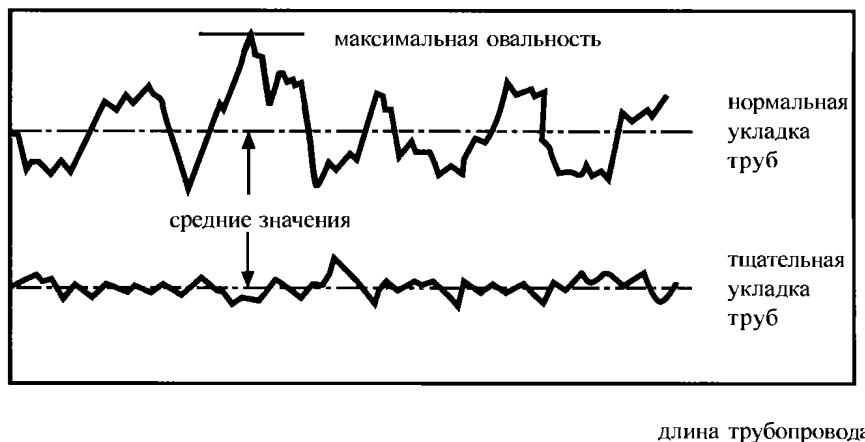
*Рис. 2.6. Фактически замеренная овальность труб вдоль участка трубопровода.*
