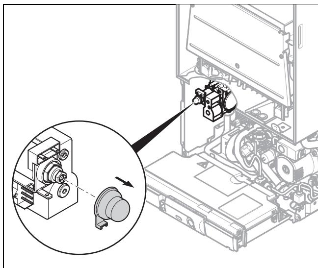
9. Снимите крышку вентиля.
